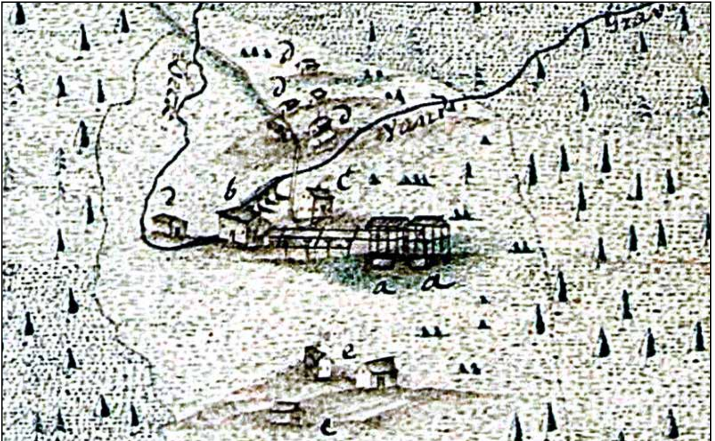
Utsnitt av karttegning fra 1765 som viser verket med de to gruvene med heiseanretning over (a), pukkverket (b), sakkerhuset der arbeiderne bodde (c), noen gamle seterhus (d) og i forgrunnen eiendommen Glabakk (e). (Etter original i Riksarkivet).
