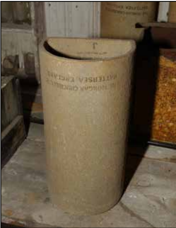
Smeltedigel fra laboratoriet. Det ble benyttet to tuper, begge produsert i England. Dette er den største typen.
