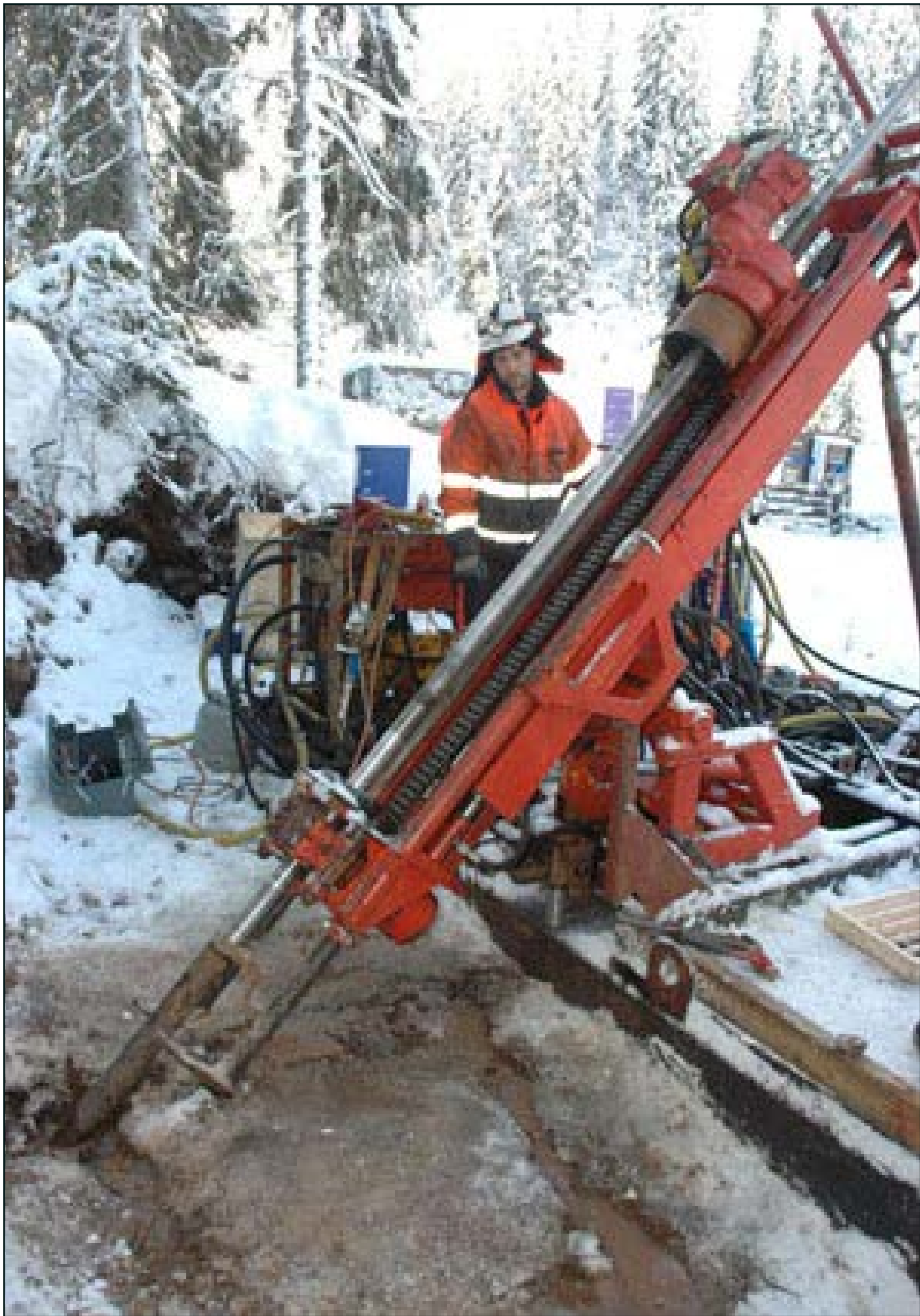
Vinteren 2008 boret selskapet Nordic Mining tre hull på 100, 150 og 170 meters dybde for å undersøke berggrunnen.
