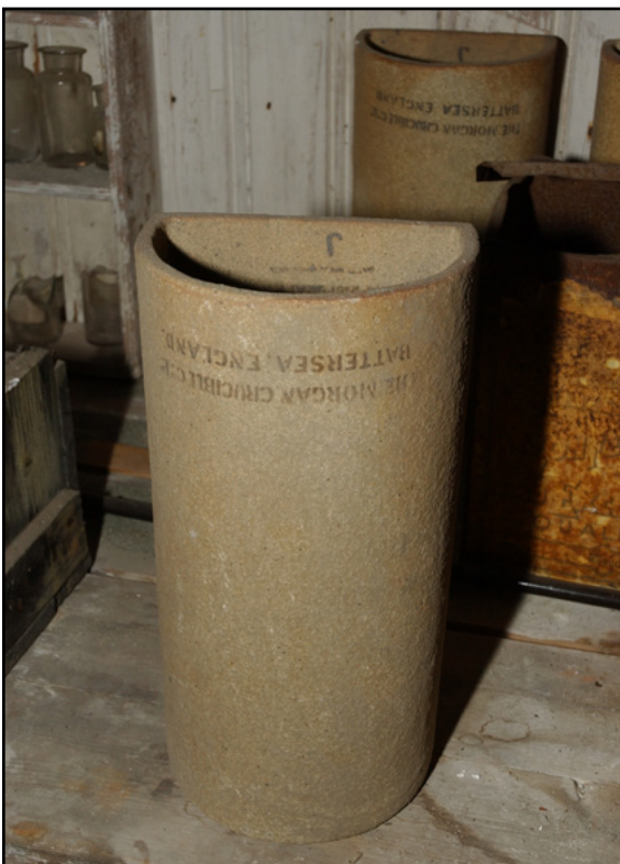
Smeltedigel fra laboratoriet. Det ble benyttet to tuper, begge produsert i England.
